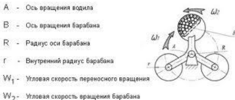
Рисунок 1 – схема центробежно-планетарной мельницы
